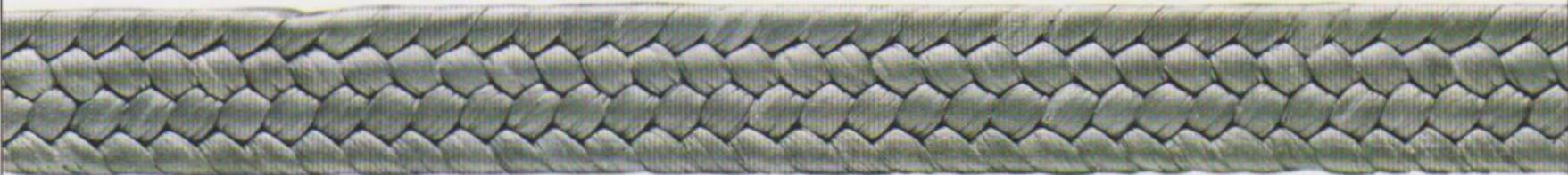
Baderna in filato di PTFE con grafite incorporata nella fibra. Altissimo potere autolubrificante, ottima resistenza chimica, elevatissima resistenza alle forti velocità periferiche.
